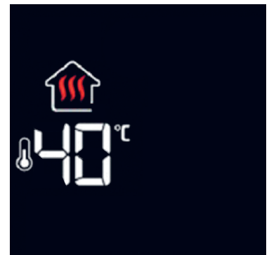
Μέγιστη θερμοκρασία λειτουργίας σε θέση "θερμοστάτης χώρου"
