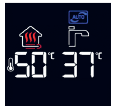
Οθόνη σε λειτουργία "Θερμοκρασία εισαγωγής κυκλώματος θέρμανσης"
